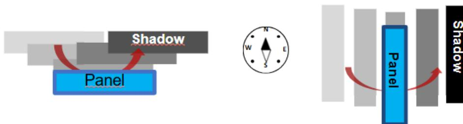
図 39 太陽光パネルを南北向き設置した場合の雲の動き
